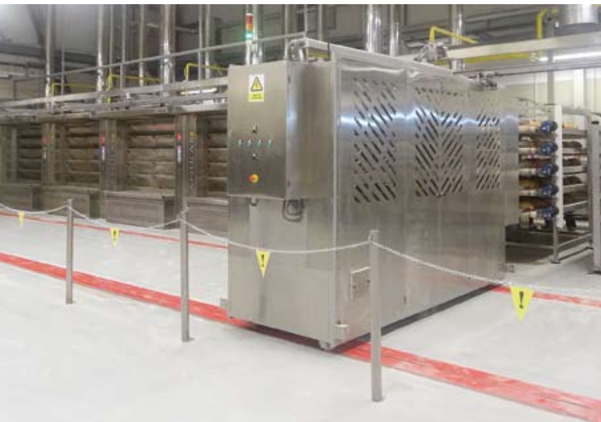
System Tagliavini Kronos może współpracować z wieloma piecami ustawionymi w rzędzie obok siebie. FOT. BAKERES
