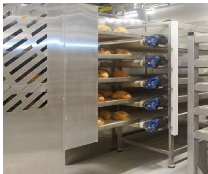
Załadunek i rozładunek pieca za pomocą wielopoziomowego systemu Tagliavini Kronos jest znacznie krótszy niż w przypadku aparatów jednopoziomowych – zapewnia włoski producent. FOT. BAKERES
